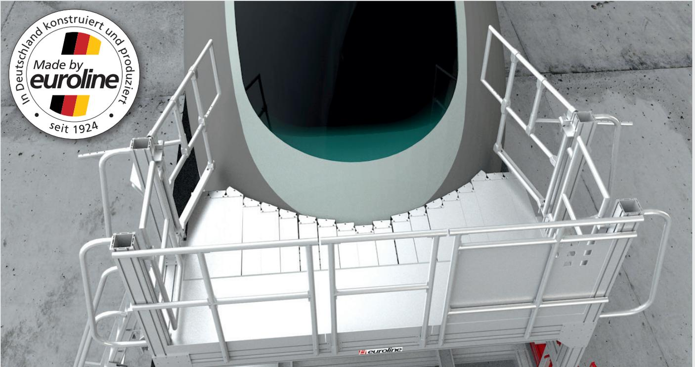
Die Kassetten fahren mit „Spaltmaß null“ millimetergenau an die Fahrzeughülle heran, damit zum Beispiel kein Werkzeug durch Lücken fallen kann. Zudem wird die Fahrzeughülle geschützt. Die Kassetten werden nach dem Heranfahren automatisch gesperrt und lassen sich erst nach manueller Entsicherung wieder einschieben. So wird verhindert, dass bei den Arbeiten versehentlich Kassetten zurückgeschoben werden und eine Stolperfalle entsteht.
